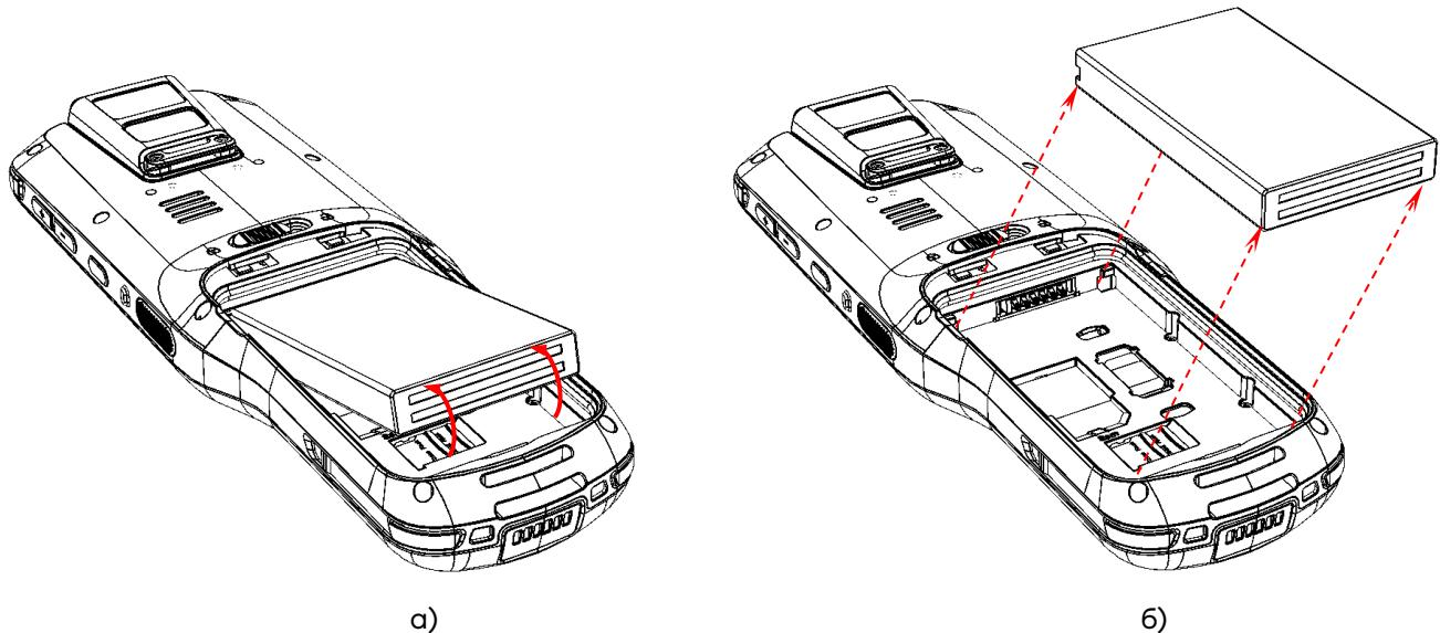
Рисунок 7. Извлечение аккумулятора:
