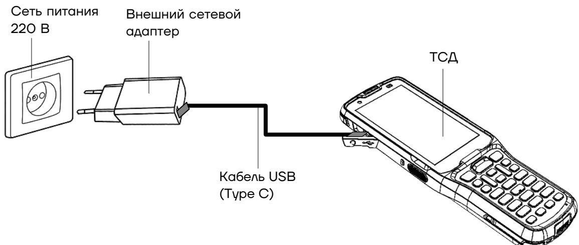
Рисунок 5. Схема подключения ТСД к сети питания
