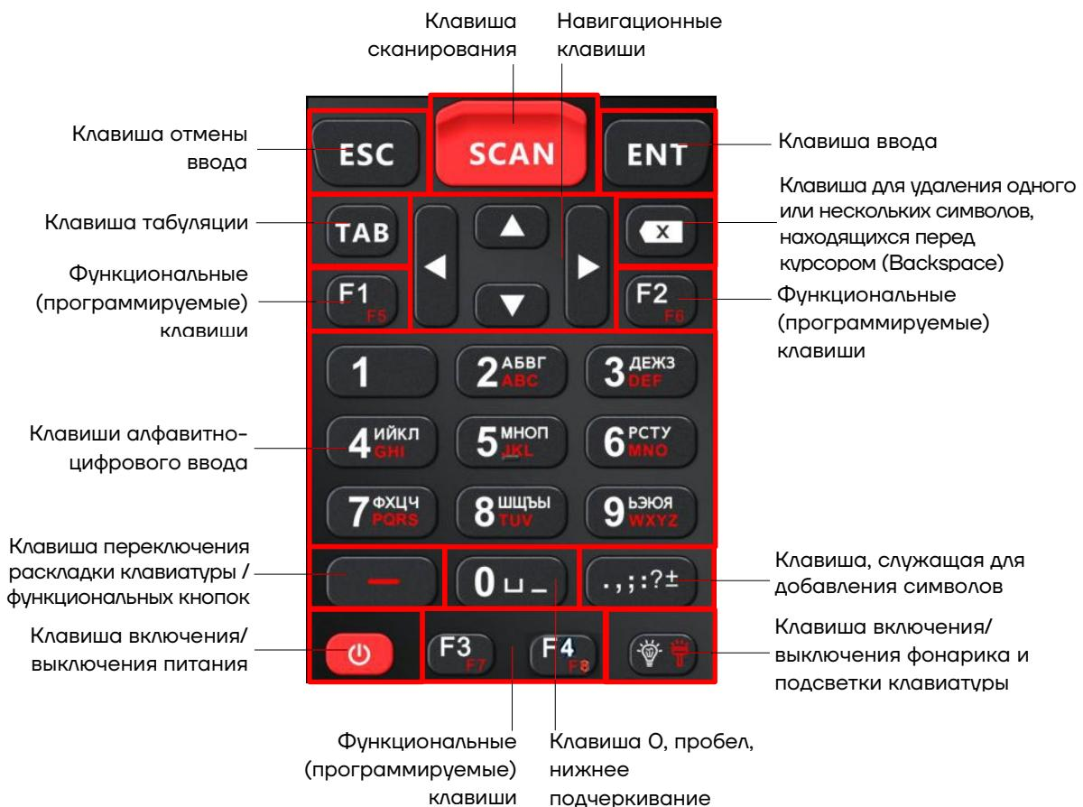
Рисунок 16. Клавиатура устройства (основные клавиши)
