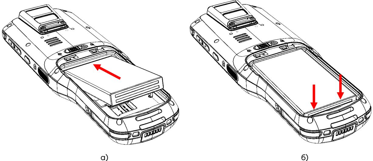
Рисунок 8. Установка АКБ:
