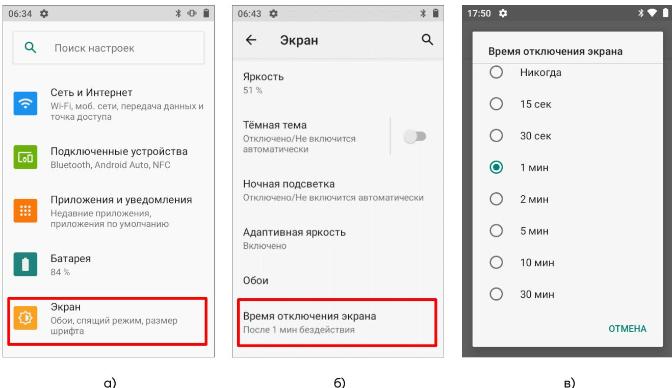
Рисунок 20. Включение «спящего» режима
